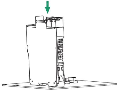
把设备的两侧与底板上相应的插槽对齐，如图中箭头方向所示，向下用力将设备卡合在底板上。
